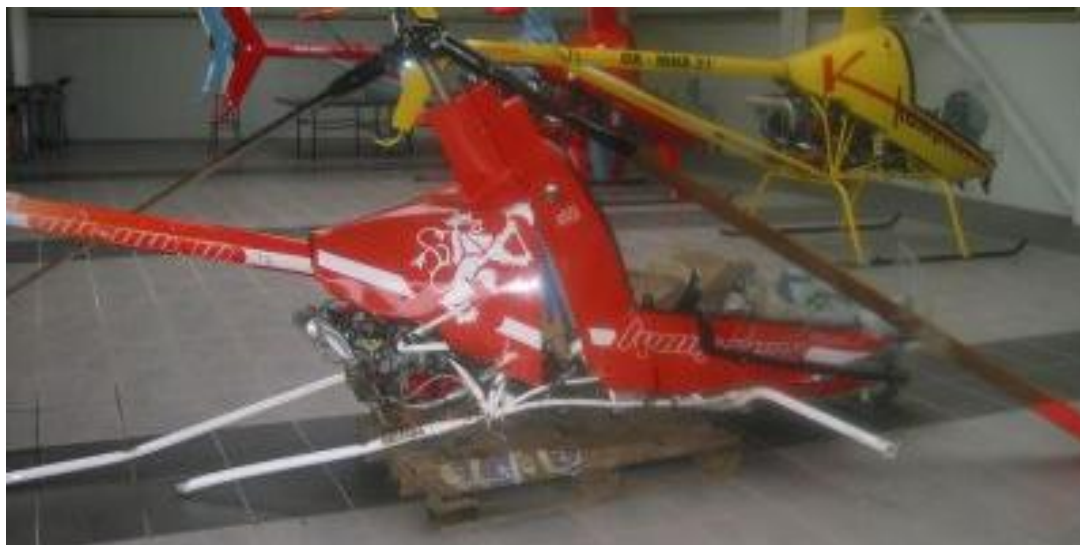
Trosky vrtulníku připravené k podrobné technické prohlídce.
