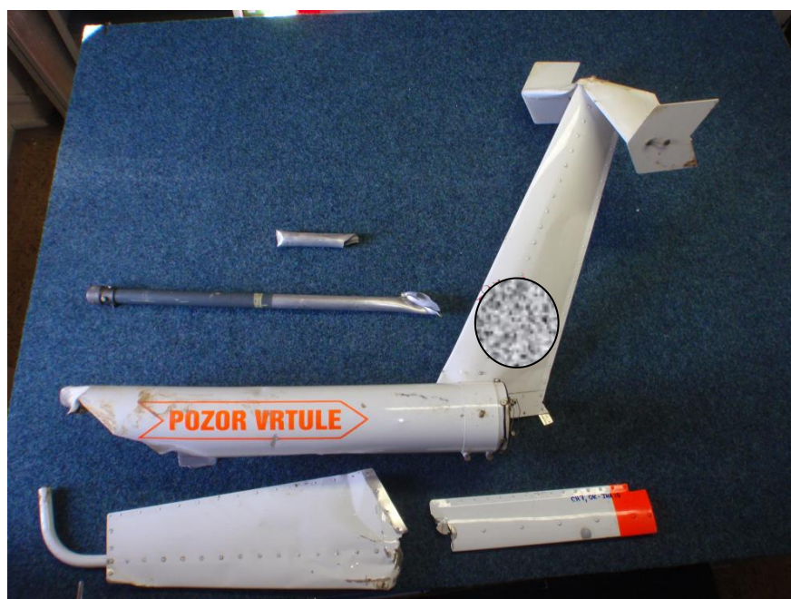
Zkoumání nalezených částí uraženého ocasního nosníku.
