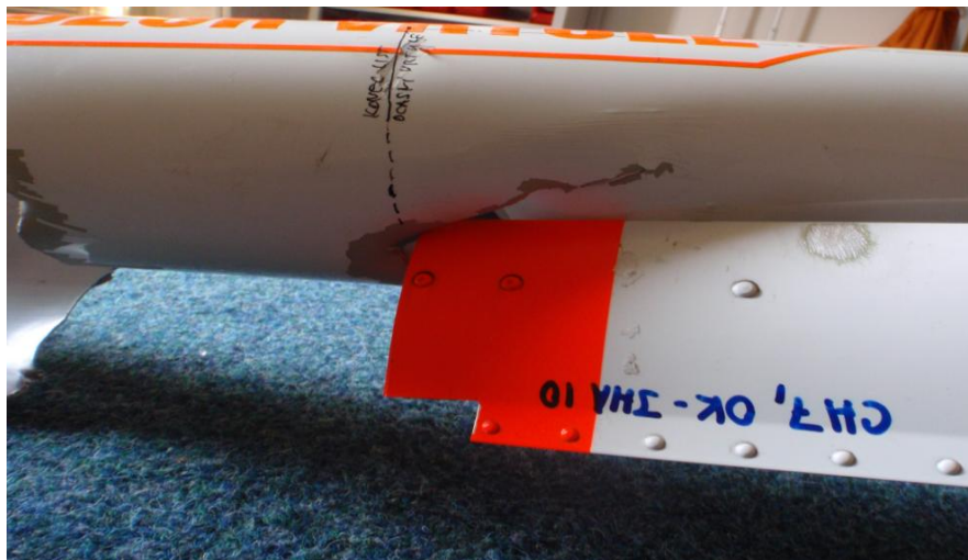
Pravděpodobná poloha listu ocasní vrtule při nárazu do ocasního nosníku
