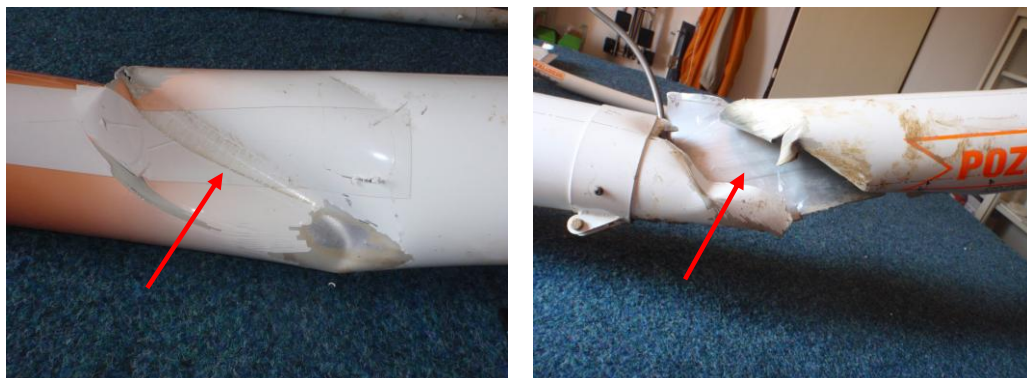
Stopy po střetu listů hlavního rotoru s ocasním nosníkem.
